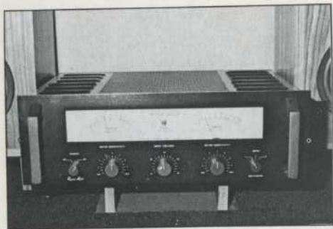
La struttura del B.A.S. P-50 è molto simile a quella del TVA-1; le valvole impiegate sono le stesse, ad eccezione delle 12AT7, sostituite dalle 12AU7, ma la potenza dichiarata è di 50 W per canale. Utili accessori sono i wattmetri a sensibilità regolabile e i doppi ingressi selezionabili dal pannello.
