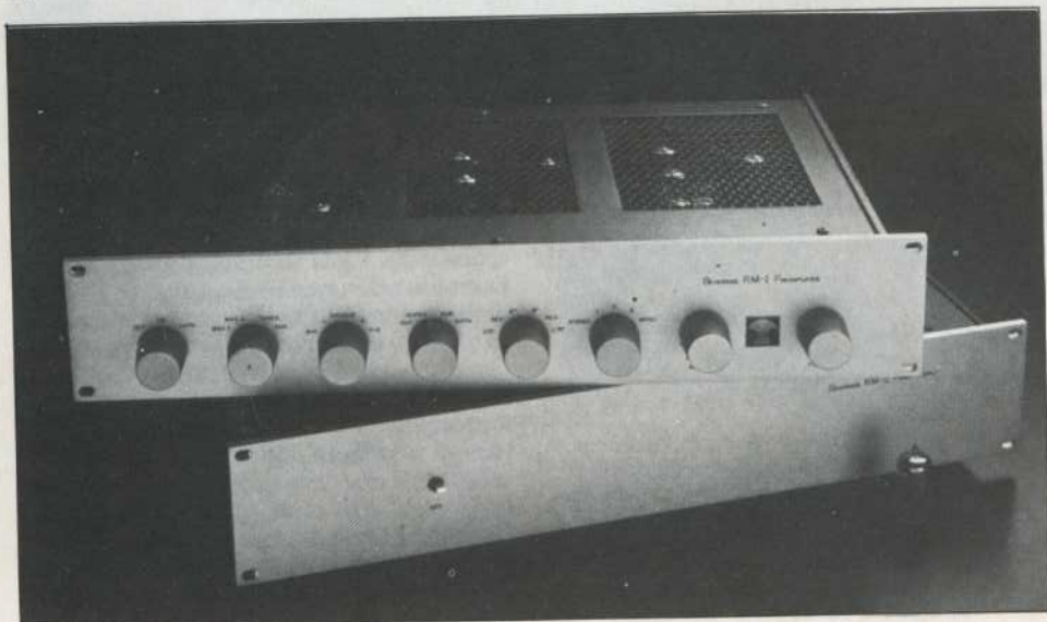
Ambizioso progetto di Roger Modjeski, il pre Beveridge RM-1 è stato recentemente rinnovato (RM-1A) ed aumentato di prezzo ($ 3.500). Impiega dodici doppi triodi 6DJ8 (ECC88) e vanta un'equalizzazione (passiva) accurata a meno di 0,05 dB, una banda di 600 kHz e uno slew-rate di 100 V/μs; l'alimentazione separata RM-2, a 6 sezioni, ha la spettacolosa capacità di livellamento di 0,48 Farad.
