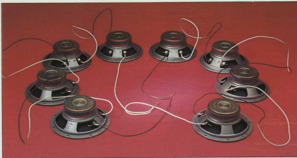
La foto mostra uno dei possibili cablaggi per gli otto woofers della I.R.S., si tratta di quello da impiegare in caso di biamplificazione, con un carico nominale di otto ohm visti dall'amplificatore (quando si voglia lavorare con un solo amplificatore, i woofers vanno posti tutti in serie, riducendone così il rendimento a quello dei mid e tweeters).
